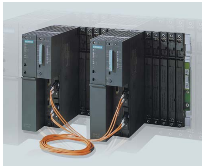
Połączone światłowodem procesorów redundantnych
