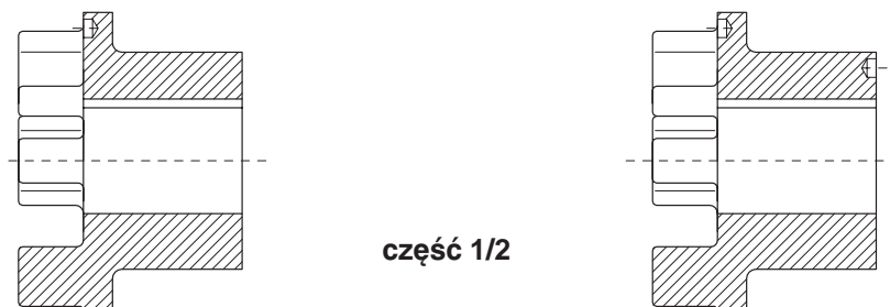
Układ otworów wyważających przy wyrównoważaniu jednopoziomowym
